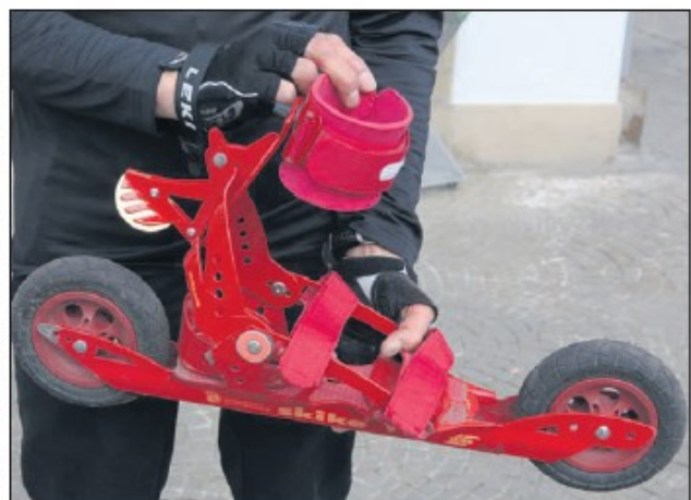
Über dem Hinterrad sitzt die Bremse, die Schuhe werden mit Klettband befestigt.
